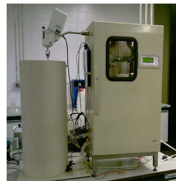
BioCalibra: dispositivo automatizado de calibración desarrollado por CALAGUA
