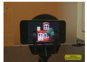
Fig. Reconstrucción 3D ortoscópica de una escena en un dispositivo electrónico de display digital 3D, mediante un array de microlentes y utilizando el algoritmo SPOC de los investigadores
